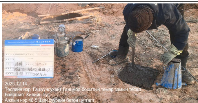
Гүүрийн В48 тулгуурын 5-р шон суурийн бетон цутгалтын суулт, агаарын агууламж, температур тодорхойлох туршилт
